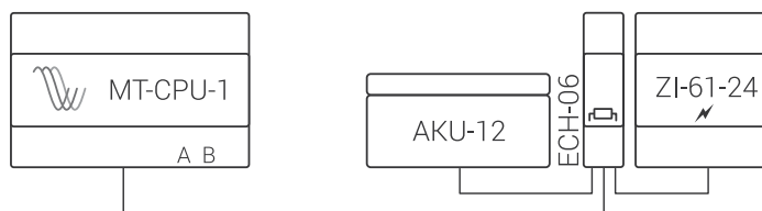
Príklad inštalácie zálohy napájania pre 9 až 30 V DC zariadenie
